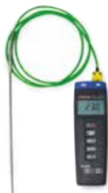
Temperatuurmeter voor RAKU-oven 100, een-voudig te bedienen, temperatuur-sensor NiCr-Ni, weergave van 20 °C - 1200 °C, aansluitmogelijkheid voor twee sensoren met omschakeling van de weergave
