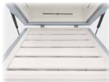
Vloerverwarming voor de gelijkmatige verwarming van grote objecten.
