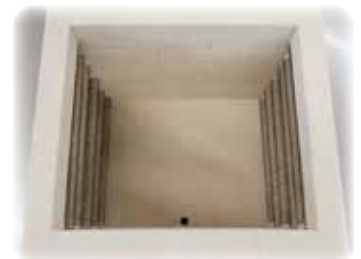
Verwarmingselementen op draagbuizen zorgen voor een vrije warmteafstraling
